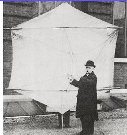
Cometa usada para levantar la antena de recepción en EEUU de la primera transmisión transatlántica de Marconi.
